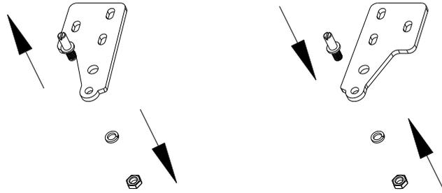
6、 Use los tornillos para ensamblar la bisagra inferior a la derecha, ensamble el pie ajustable. Use los tornillos para ensamblar el pie delantero a la izquierda.
