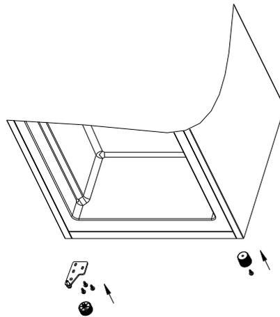
7、 Ensamble la puerta y la cubierta superior. Fije la cubierta superior con tornillos y fije la cubierta del tornillo.
