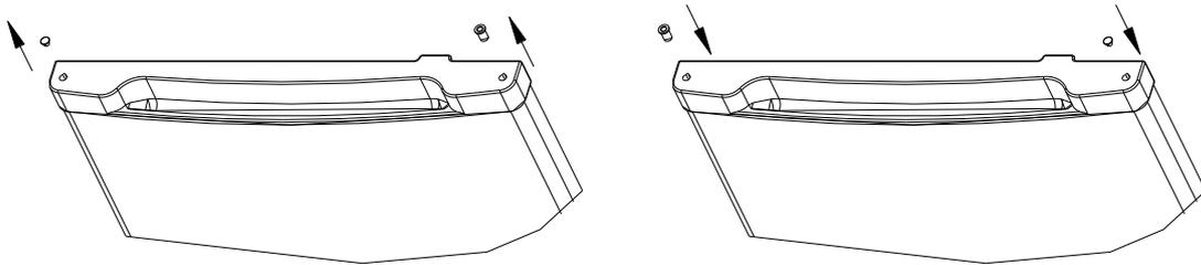
4, Retire el pie ajustable de la parte inferior de la unidad. Retire los tornillos y la bisagra de la izquierda y retire el pie delantero de la izquierda.
