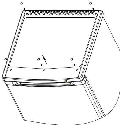
2, voltee la cubierta superior, retire los tornillos. Busque la bisagra del lado izquierdo de la cubierta superior y use los tornillos para ensamblar la bisagra en el lado derecho de la cubierta superior.
