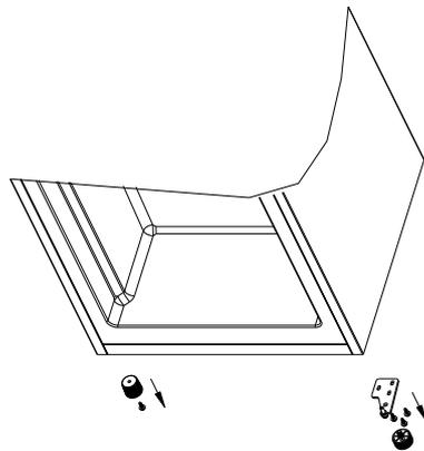
5、 Retire la tuerca de la bisagra inferior, retire el resorte y el pasador. Luego gire la bisagra inferior. Usando la tuerca y el resorte para fijar el pasador.
