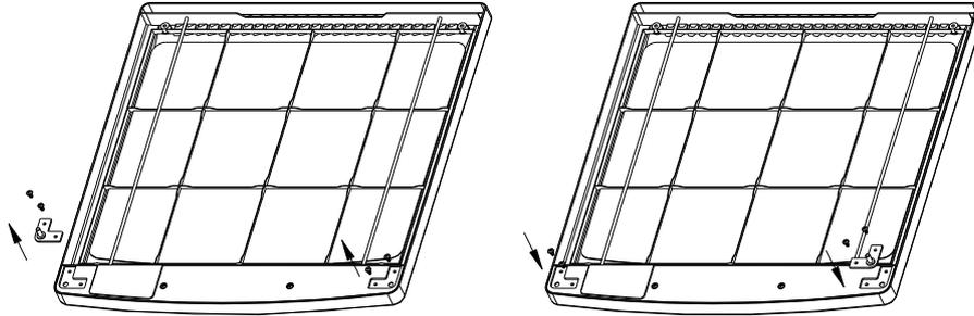
3, retire la puerta. Saque la funda de la parte superior de la puerta izquierda y el tope de la parte superior de la puerta derecha. Luego coloque la funda en la parte superior de la puerta derecha y el tope en la parte superior de la puerta izquierda.
