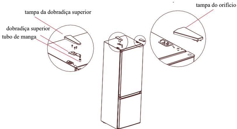
3. Desmontar a dobradiça central, os parafusos, as tampas dos orifícios dos parafusos e retirar a porta do congelador.
