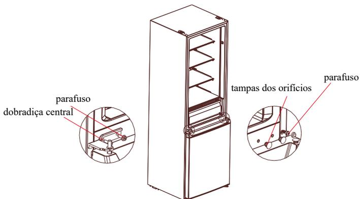
4. Desmontar a dobradiça inferior, as tampas dos orifícios e os parafusos, instalar o eixo da dobradiça inferior do outro lado da dobradiça inferior, depois instalar a dobradiça do outro lado.
