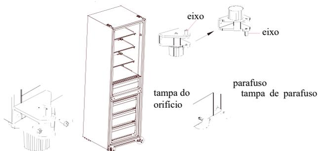
5. Desmonte o parafuso de rolha, o tubo de manga e a rolha da porta de refrigeração e da porta do congelador, Em seguida, instale-os no outro lado das portas em ordem. Troque a posição do tubo da luva e do tampão do furo na tampa superior da porta de refrigeração e instale a luva superior da dobradiça na porta do congelador ao furo do outro lado da luva do eixo.
