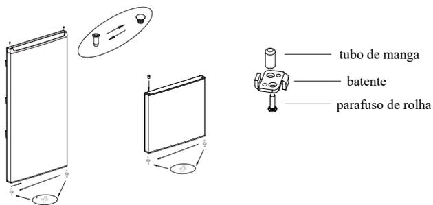
6. Colocar a porta do congelador na dobradiça inferior, instalar a dobradiça do meio, os parafusos e as tampas dos orifícios dos parafusos.
