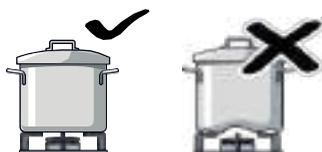
Não utilize recipientes com bases convexas ou côncavas. Desta forma, os pratos podem ser virados. Use apenas placas com fundo plano. Se você usar o adaptador de queimador wok para o processo de cozimento, você pode usar placas convexas.
